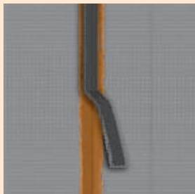
Abb. 2: FERMACELL Dichtband in die zuvor aufgetragene, noch feuchte FERMACELL Flüssigfolie drücken und direkt mit Flüssigfolie überstreichen
