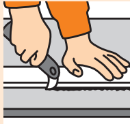
Bild 2: Einmessen und Einritzen
