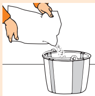
Bild 21: FERMACELL Fugenspachtel ins Wasser einstreuen
