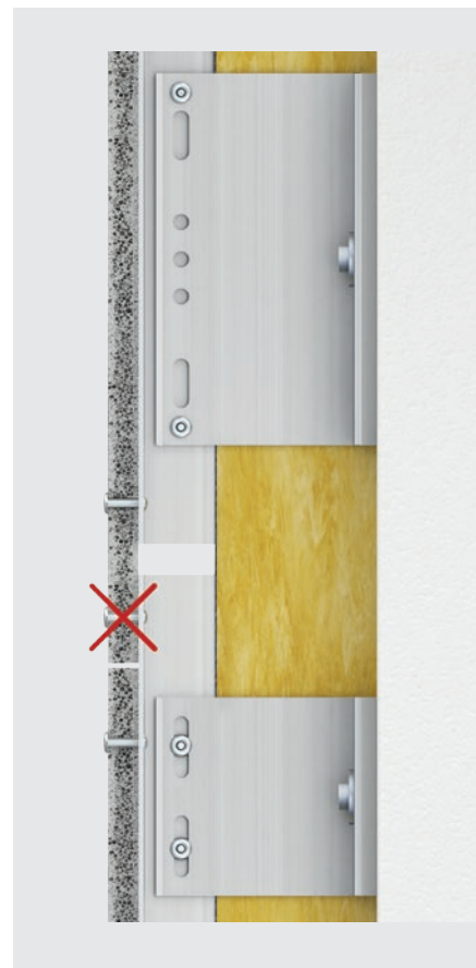
Detail A: Ausbildung von Fest- und Gleitpunkten
