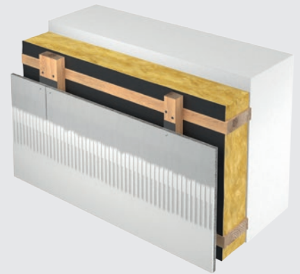
Bild 1: Variante mit Konterlattung
