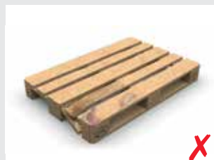
Bruch eines Querbretts
