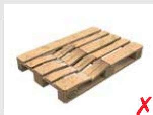
Schäden an mehr als 3 Bauteilen
