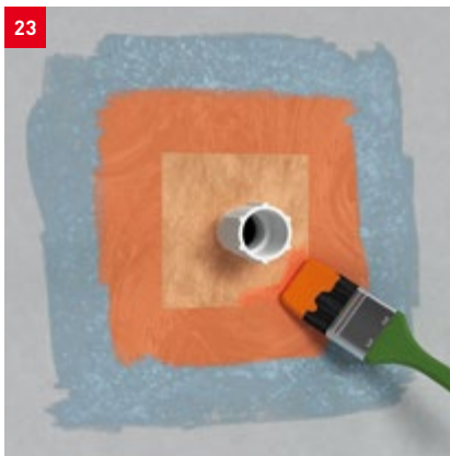
fermacell™ Wanddichtmanschette in die noch feuchte fermacell™ Flüssigfolie einbetten und anschließend erneut überstreichen
