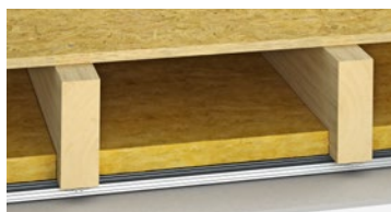
Geschlossene Holzbalkendecke, Unterdecke federnd abgehängt
