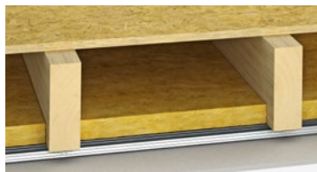
Geschlossene Holzbalkendecke, Unterdecke federnd abgehängt
