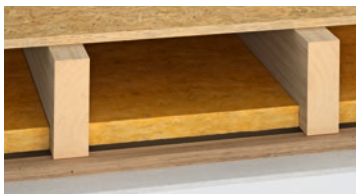
Geschlossene Holzbalkendecke, Unterdecke auf Lattung
