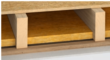
Geschlossene Holzbalkendecke, Unterdecke auf Lattung
