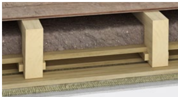
Geschlossene Holzbalkendecke, Einschub nicht tragend
