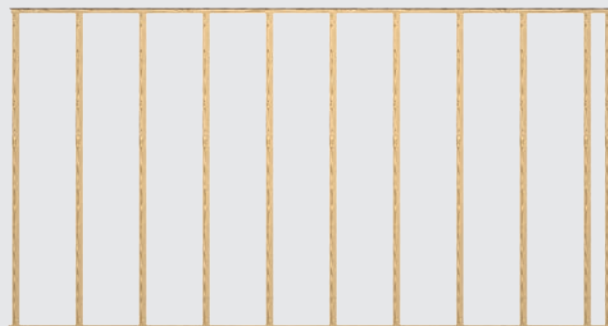
Achsabstand Unterkonstruktion max. 500 mm
