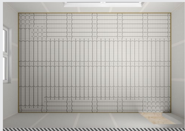
Verlegscheema mit zwei Heizkreisen
