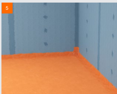
Vollflächige Abdichtung der Fläche im Bereich W1-I
