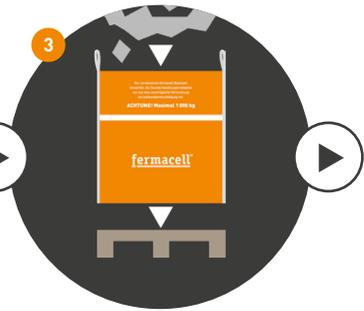
Befüllen und verschließen Sie die Big Bags gemäß der Anleitung und stellen Sie diese zur leichteren Handhabung auf eine EPAL Palette.
