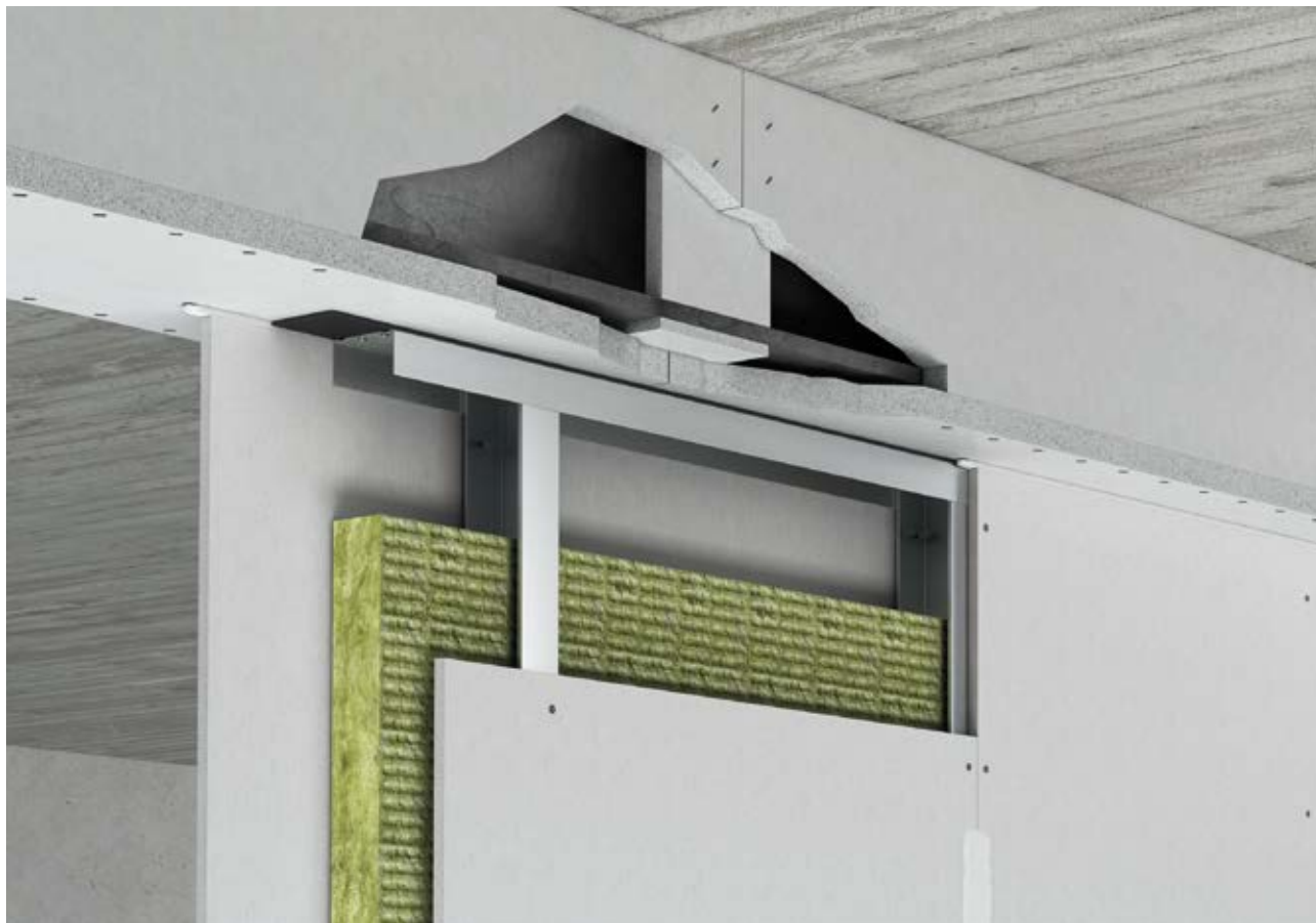
Detaillösungen Anschluss Trockenbauwand an bekleidete Stahlträger
