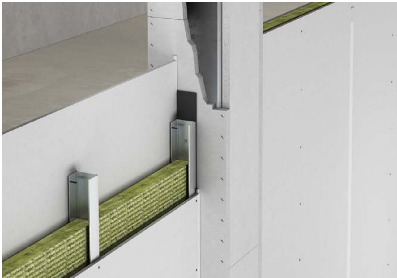
Detaillösungen Anschluss Trockenbauwand an bekleidete Stahlstützen
