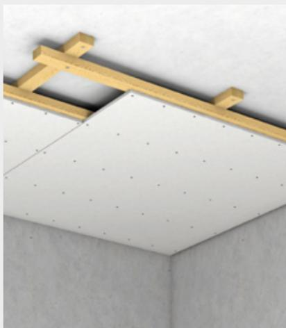
Direkt befestigte Decke mit Holz-Unterkonstruktion
