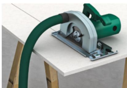
Es empfiehlt sich eine Handkreissäge mit Hartmetallbestückung und geringer Drehzahl sowie einer Absaugung mit Nachlauf.
