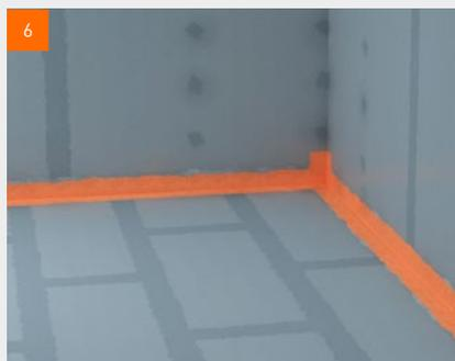
6 Bei Verwendung von Powerpanel TE in Klasse W1-I: fermacell™ Abdichtungssystem nur im Randbereich
