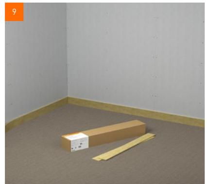
9 Bei Bedarf erfolgt das Anbringen eines Randdämmstreifens
