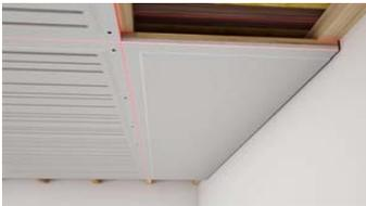
**fermacell** ACOUSTIC big board besteht aus einer 12,5 mm dicken Gipsfaser-Platte mit umlaufender Trockenbaukante und 12,5 mm dicken Verstärkungsholzleisten auf der Rückseite. Dies ermöglicht eine Montage der Platten an Holzunterkonstruktionen und Balkenlagen.
