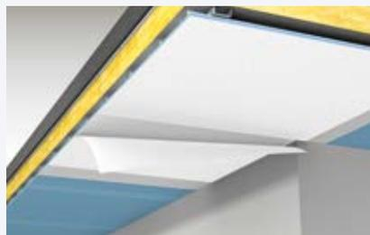
Das fermacell™ Powerpanel Malervlies wird von der Rolle oder als Zuschnitt in den nassen Anstrich falten- und blasenfrei mit einer Überlappung von ca. 50 mm Breite eingelegt. Dabei sollte darauf geachtet werden, dass die Überlappung nicht im direkten Fugenbereich liegt und ggf. die Fugenarmierung durch den anschließenden Doppelschnitt beschädigt wird.
